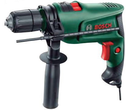
Taladro percutor Bosch Easy impact 600 600 W. 45.000 ipm. Portabrocas Ø 13 mm. 0-3.000 rpm. Control electrónico de velocidad. Maletín de transporte. 1,7 kg. 5585X679
